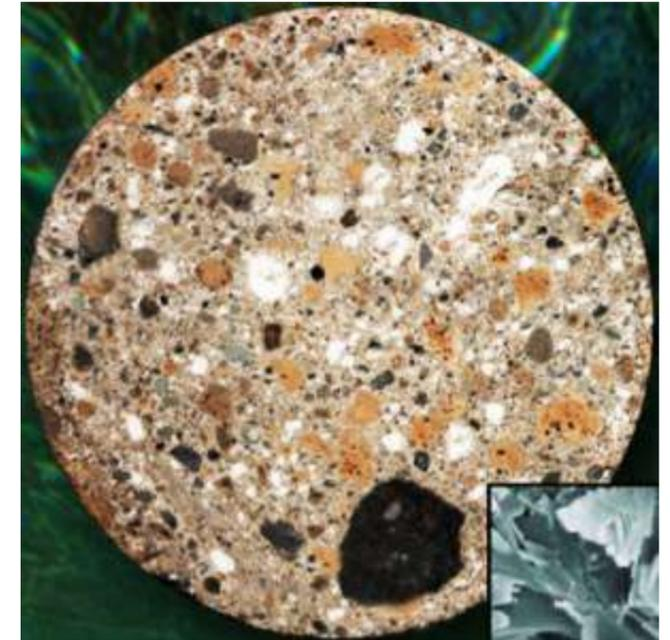
Photo: Les inclusions jaunâtres sont la pierre ponce, les fragments de pierre sombre sont des laves, les zones grises sont constitués d'autres matériaux cristallins volcaniques, et les taches blanches sont de la chaux. L'encart est une image au microscope électronique à balayage des cristaux particuliers (tobermorite) essentiels à la qualité supérieure du béton à l'eau de mer des Romains.
